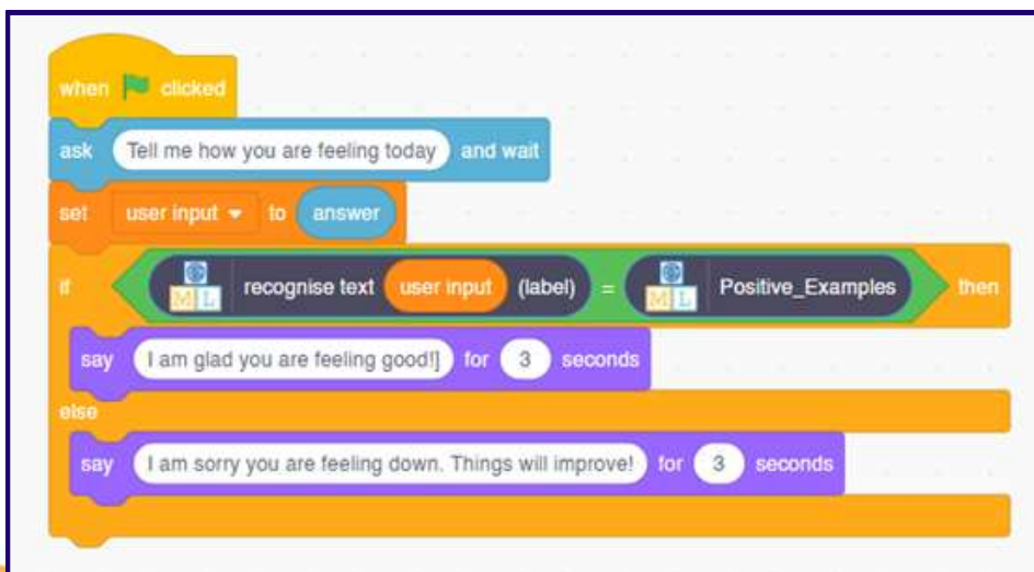
Figura 4 Secuencia de bloques de código en Scratch que ilustra una cadena básica de evento-acción: Scratch de MIT Media Lab
