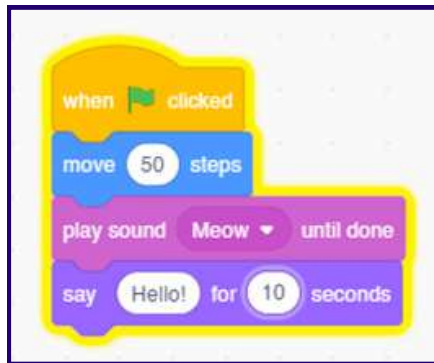
Şekil 3 Hareket ve ses etkileşimi için Scratch blok mantığı: MIT Media Lab tarafından geliştirilen Scratch
